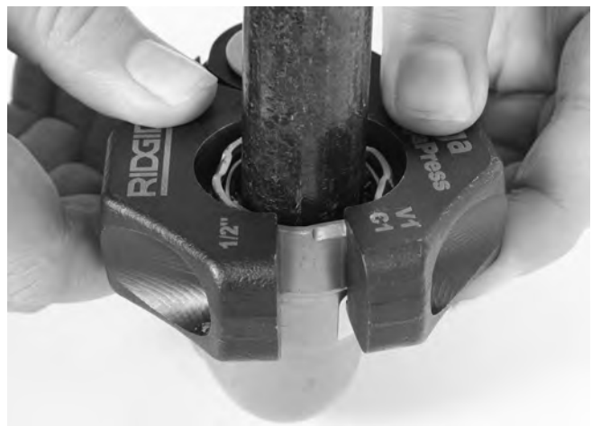
Figure 11 – Engagement de la bague de sertissage sur le raccord
